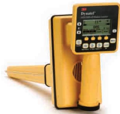
Los localizadores de cables y averías Dynatel encuentran el recorrido exacto y la profundidad estimada de cables, tuberías metálicas y no metálicas, localizan marcadores pasivos enterrados o simplemente leen y escriben información en los nuevos marcadores activos. Además identifican y miden puntos de daño de cables cuando existe un contacto metálico a tierra vía un conductor o un blindaje de cable.
